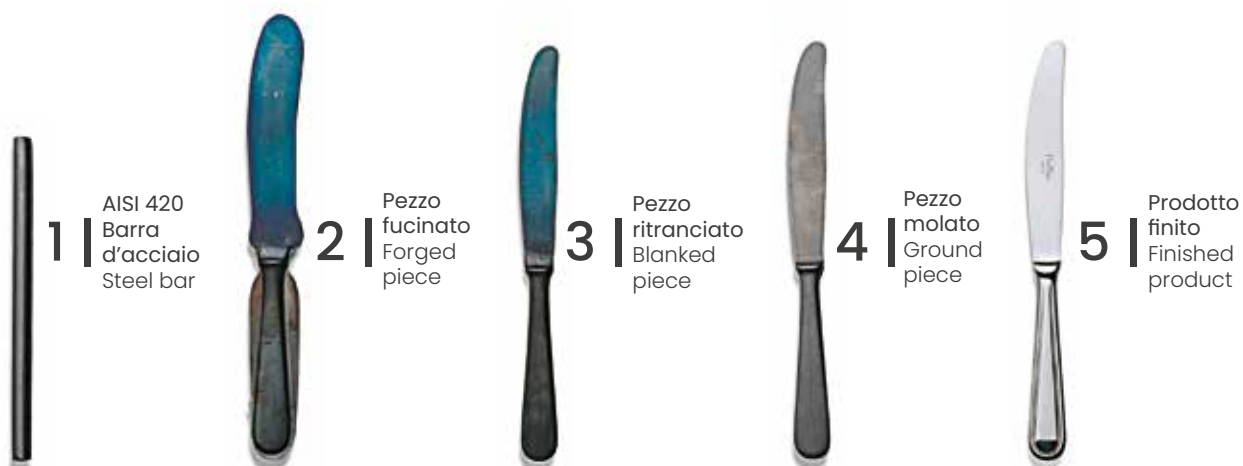
COLTELLO MONOBLOCCO CON LAMA TEMPERATA | Solid knife with harder blade
